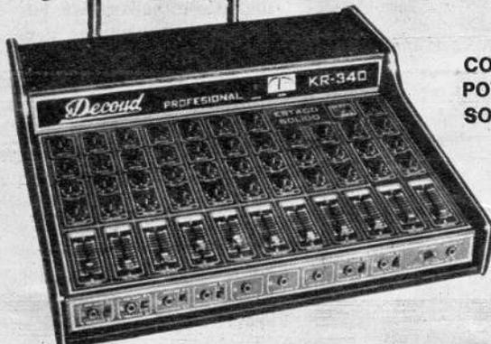
**CONSOLA: K-R-340** de 280 watts, 9 canales para micrófonos de impedancia balanceada con reverberancia para conjuntos o disc-jockeys, 2 canales para fono magnético.
