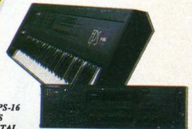
El EPS-16 PLUS DIGITAL SAMPLING Workstation. Sampling de 16 bit con efectos en 24-bit, se quencer y controles de ejecución, disponible en teclado o rack.
